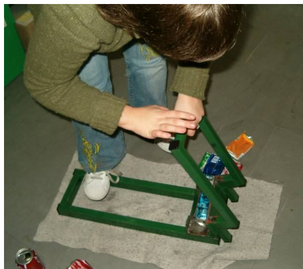
Zgniatanie puszek zgniataczem oraz segregowanie na puszki aluminiowe i stalowe
